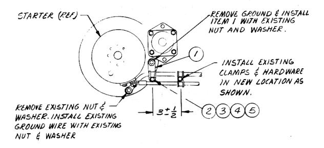
GROUND WIRE BRACE INSTALLATION
